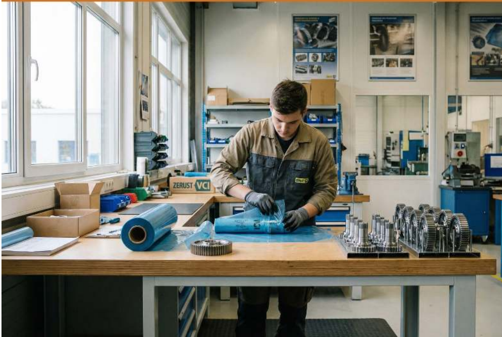
Emballage de pièces métalliques avec film VCI pour prévenir la corrosion pendant le stockage
