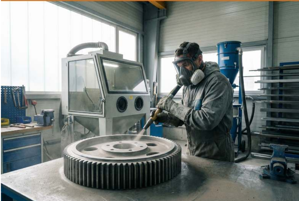
Sablage mécanique pour préparation de surfaces avant peinture, élimination de contaminants
