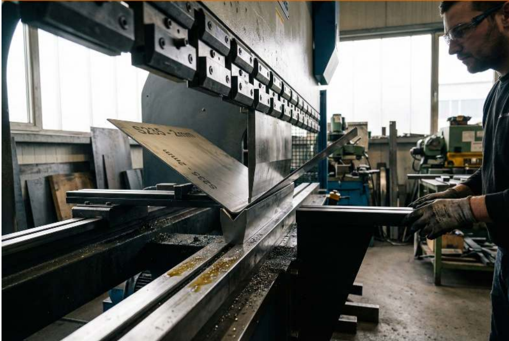
Pliage de tôle S235 avec presse-plieuse, ajustement de l'angle et de la force selon l'épaisseur
